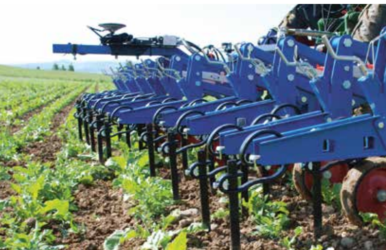
Grâce aux nouvelles technologies, le binage transversal de la betterave sucrière avec une précision de 2 cm est devenu une réalité.
